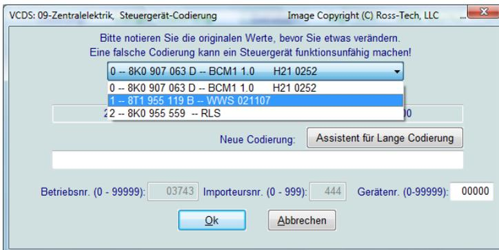
Wie auch bei normalen Steuergeräten ist nicht jedes Subsystem auch codierbar, in einem solchen Fall wird **VCDS** die Möglichkeit der Codierung für die betroffenen Systeme ausblenden.
