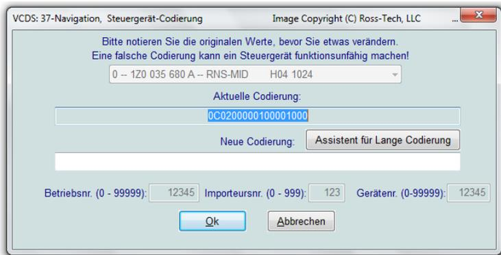
Zum einfacheren Umgang mit der langen Codierung bietet **VCDS** Ihnen das Plugin LCode, den **[ Assistent für lange Codierung ]**, um die einzelnen Bytes der Codierung aufzuschlüsseln (siehe [Abschnitt 6.1.2](#)).
