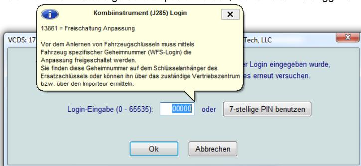
Rückmeldung (nur KWP-2000/6000). Ältere Steuergeräte (nur KWP-1281) trennen bei falschem Freischaltcode die Verbindung, Sie erhalten dann einen Hinweis seitens **VCDS**.
