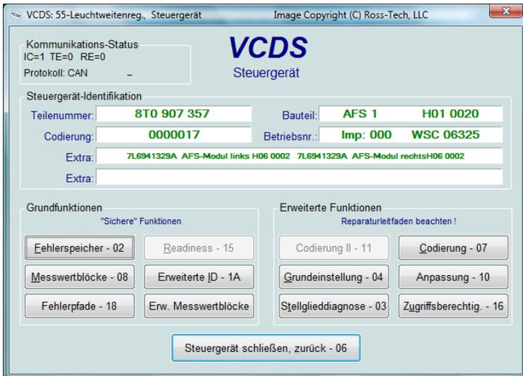
Das Feld Kommunikationsstatus gibt Auskunft zur Datenübertragung mit dem angewählten Steuergerät. Neben dem verwendeten Protokoll werden zusätzlich Informationen zur Verbindung aufgezeigt.
